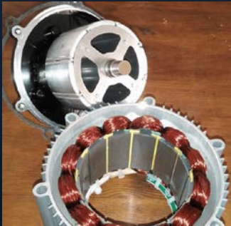
Rotor cu magneți permanenți plasați pe suprafață
