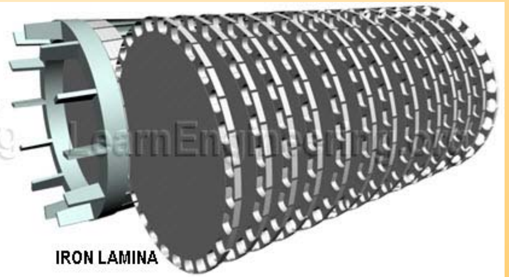
Circuit magnetic rotoric „expandat”
